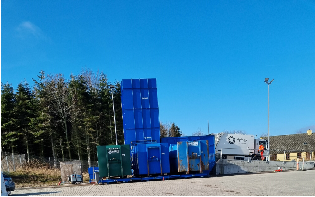
3 komprimatorcontainere med henholdsvis madaffald, restaffald og papaffald.
