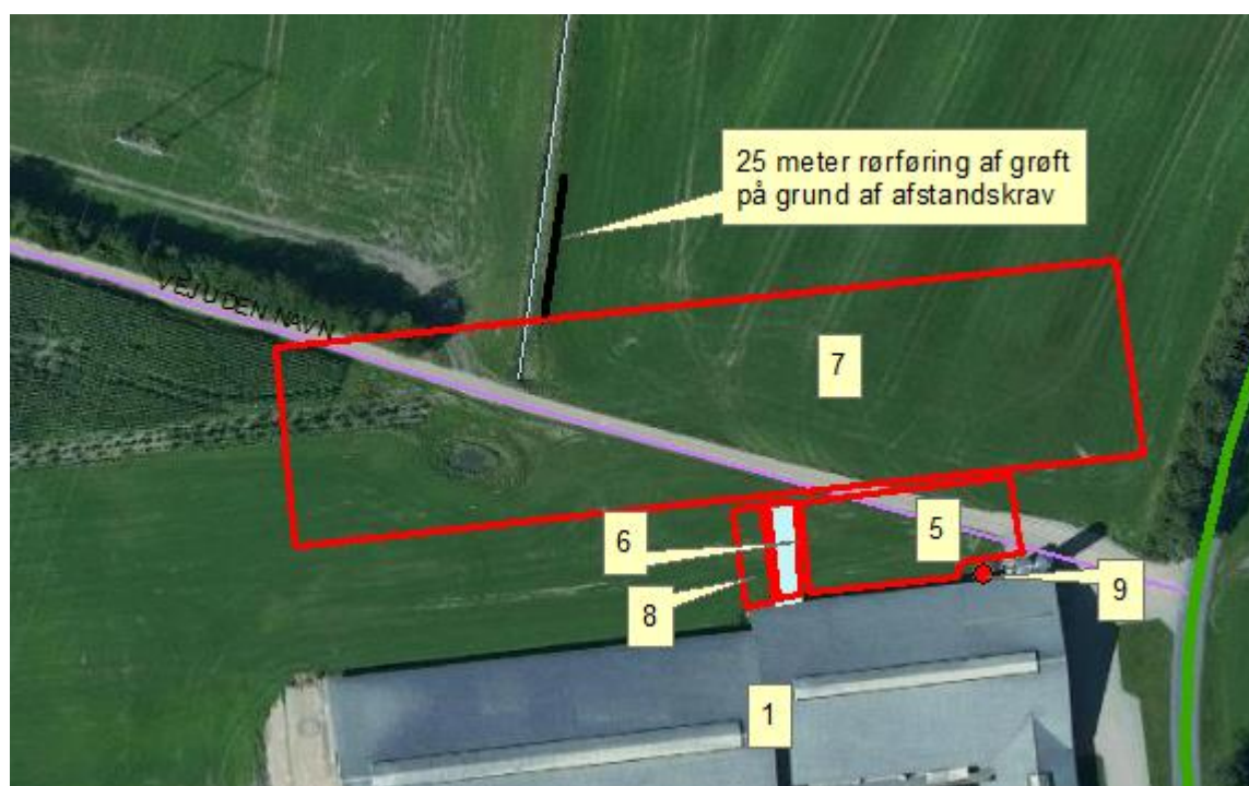
Figur 2. Varde Kommune stiller vilkår om 25 meters rørføring af grøft fra kostald.
