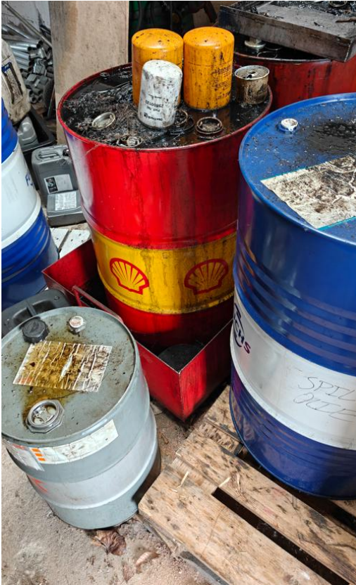
Olietønde i spildbakke med oliefiltre til afdrypning.
