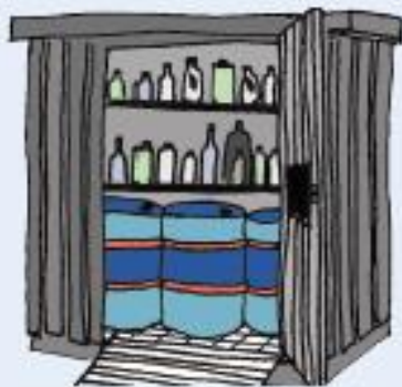
Figur 2: Udendørs opbevaring i container med dobbelt bund.
