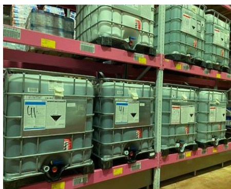
Figur 2. Pallecontainere i reoler på kemilager (a.1)
