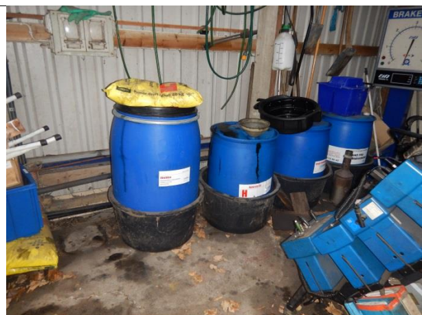
Foto 4: Opbevaring af farligt affald (fra venstre oliefiltere, kølervæske, bremsevæske og vand fra bremsevask).
