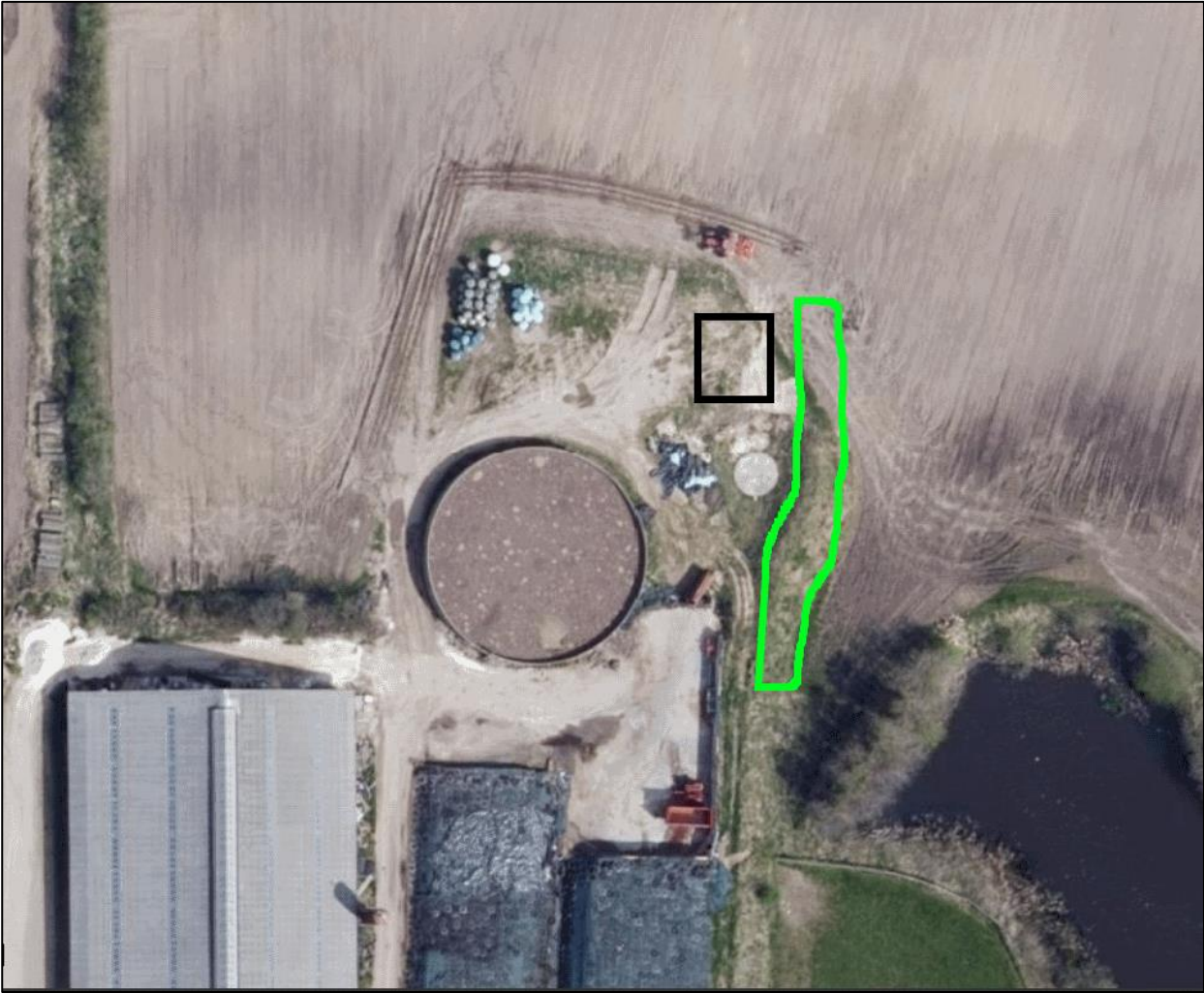
Figur 3.2.3 Ønsket placering af møddingsplads indtegnet med sort, krævet forlængelse af vold, indtegnet med grønt.
