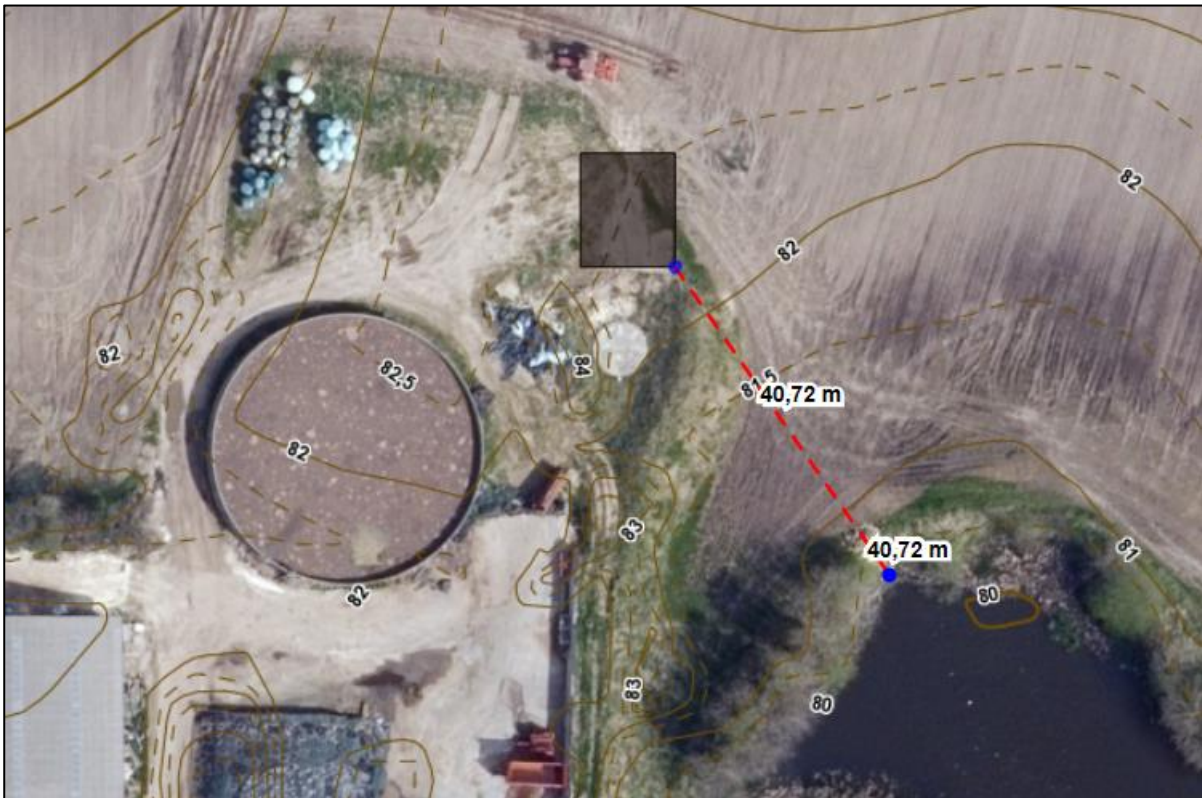
Figur 3.1.3 Ny møddingsplads, 3 sider med 3 meter høje sider, åbning mod vest. Med højdekurver og afstand til sø, øst for ejendommen.
