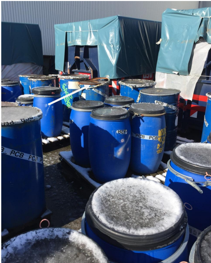
Foto 3: Tønder med PCB-affald, fem løse låg og resten mangler spændebånd til låget. I stedet for spændebånd til lågene er der brugt tape.
