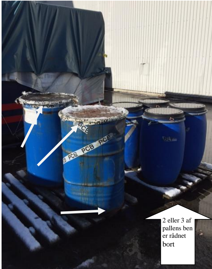
Foto 1: Tønder med PCB-affald, rustne tønder og løse låg. I stedet for spændebånd er der brugt markeringstape.
