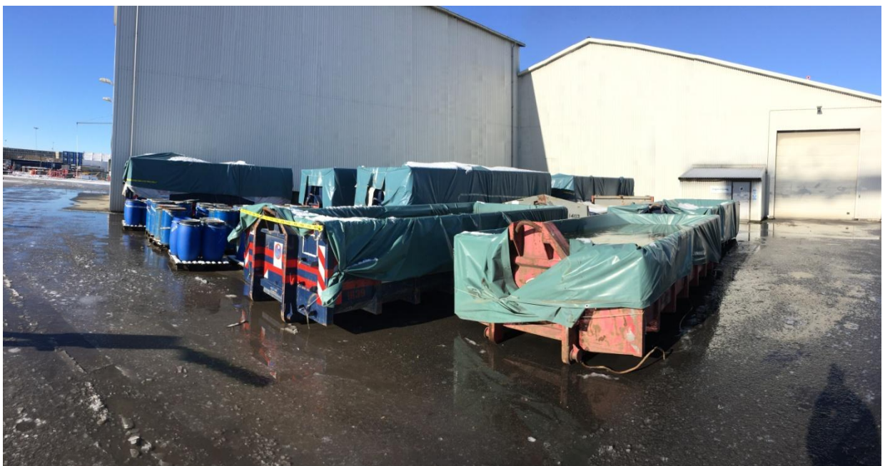
Foto 4: otte containere med PCB-affald. Presenningerne er tynget ned af smeltevand og stort set fyldt op.
