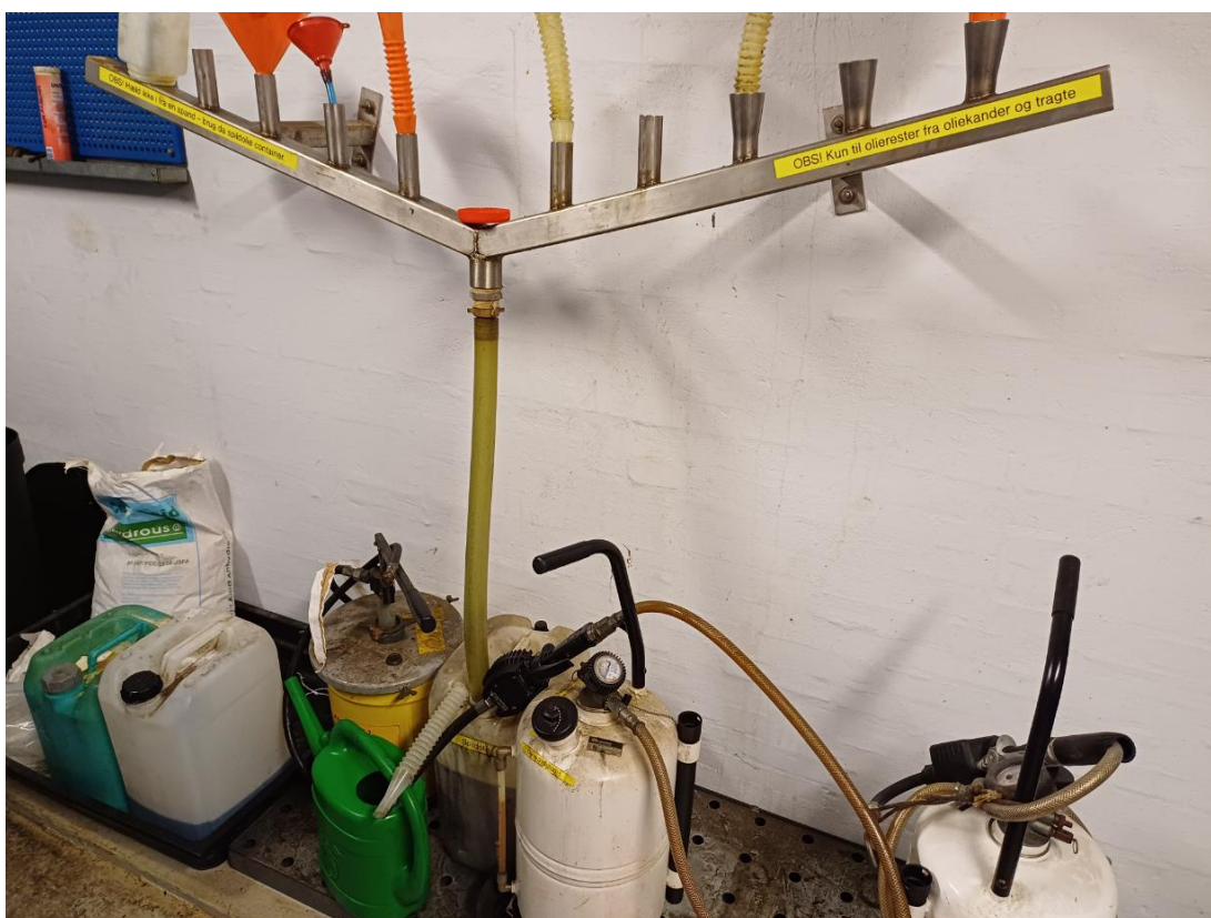
Foto 3. Stativ til afdrykning af brugte kander og trugte.
