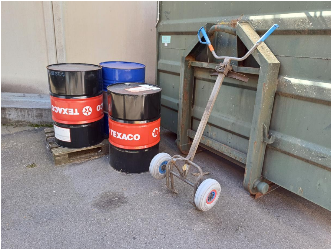
Foto 5. Oplag af farligt affald uden for miljøcontainer. Beholderne står udendørs uden spildbakke.
