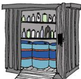
Figur 2 Udendørs opbevaring i container med dobbelt bund.
