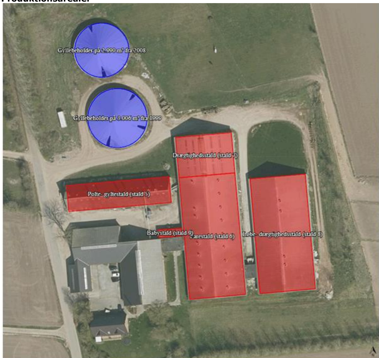
Figur 1: Husdyrbrugets stalde, opbevaringsanlæg mv. – se også bilag 1
