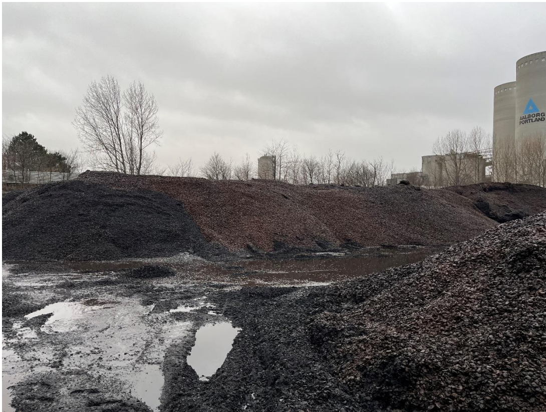
Utildækkede oplag af cashewskaller på kulpladsen
