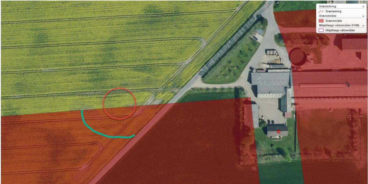
Figur 1. Søgerende til dræn ved ny gyllebeholder
