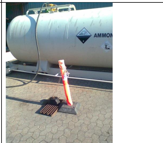
Billede nr. 7: Afspærringsballon i brug (2013)
