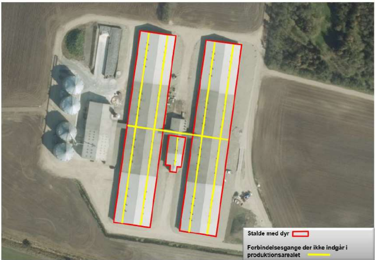
Oversigten viser hvilke større forbindelsesgange, der er udtaget af produktionsarealet. Der er derudover udtaget inspektionsgange og krybber.
