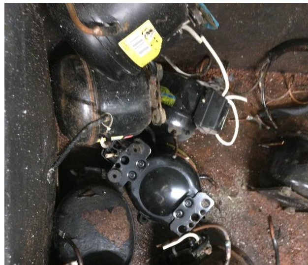
2. Kasse med CFC kompressorer
