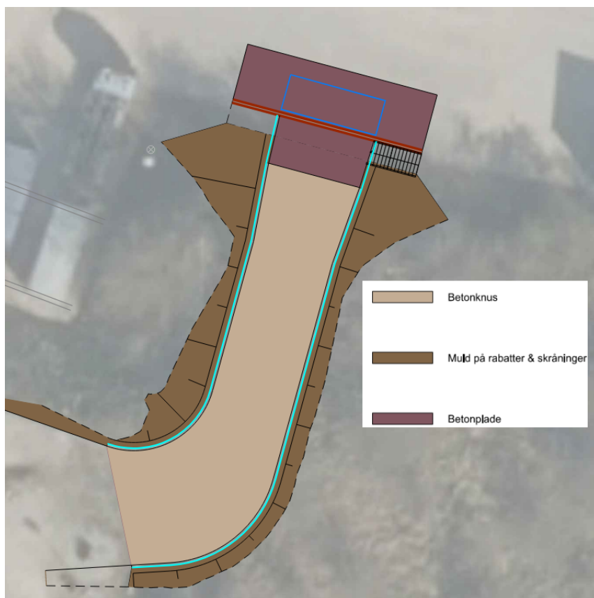
Belægningsplanen – kørevej og betonplader v støttemur
