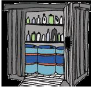
2 Udendørs opbevaring i container med dobbelt bund
