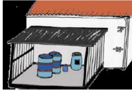
3 Udendørs opbevaring under tag med tæt bund og opkant
