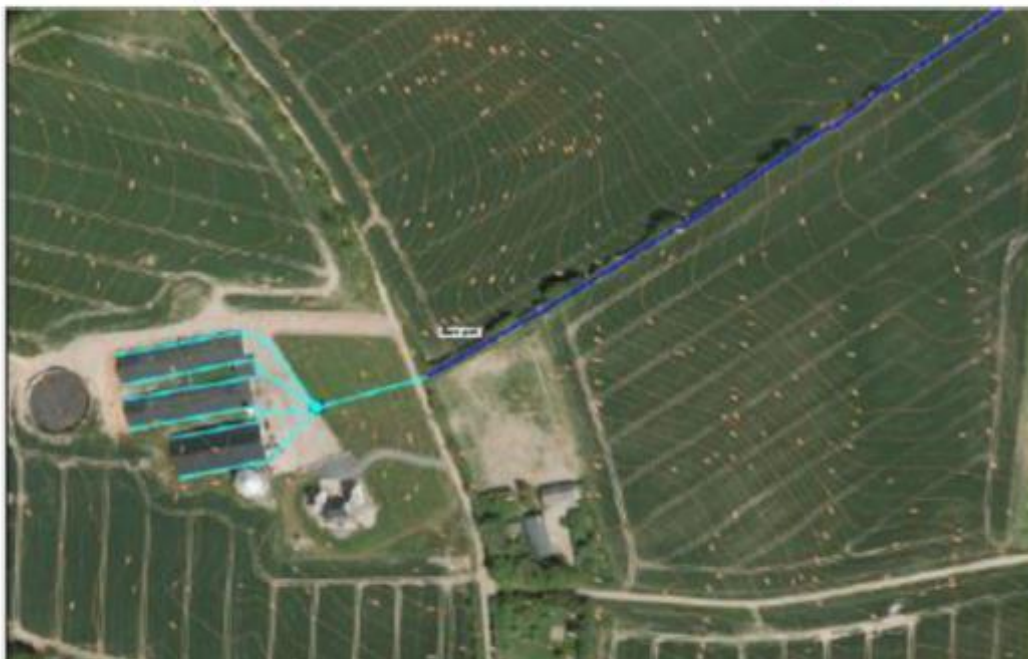
Figur 2B. Tagvand bortledes til åben rende på modsatte side af Horløkkevej.
