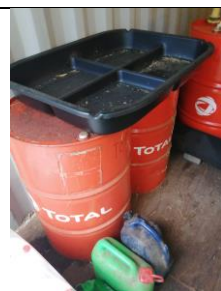
Billede nr. 15 Opsamlingsbakke som placeres under påfyldningsstudsene ved påfyldning af dieselolie.
