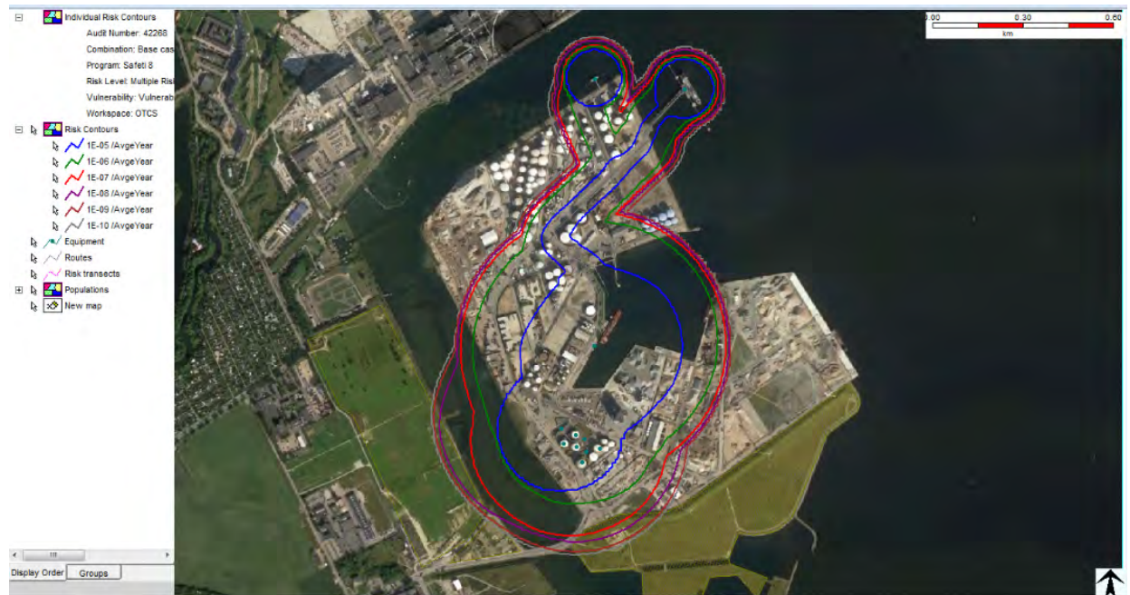
Figur 6-4 Iso-risikokort med angivelse af risikoniveauer for dødsfald for personer pga. brand omkring tanke, rør, pumper, slanger og lossebomme ved 24 timers eksponering om dagen, 365 dage om året.
