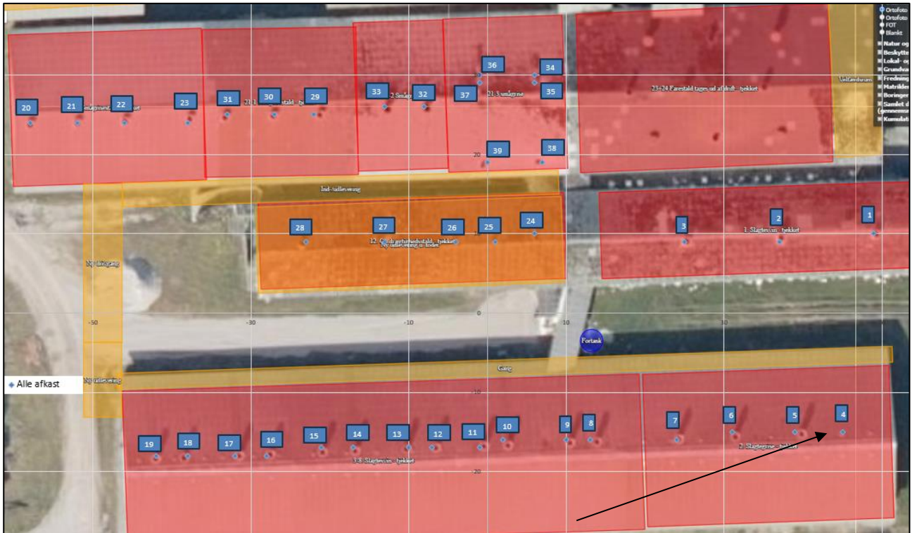
Placering af ventilationsafkast. Ventilationsafkast nr. 4 ny etableres.
