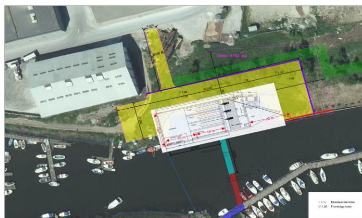
Figur 3 Pumpe/sluse bygværket. I hvid ses selv pumpehuset, i gul omkringliggende belægning, i turkis sluseporten og i rød slusevæg
