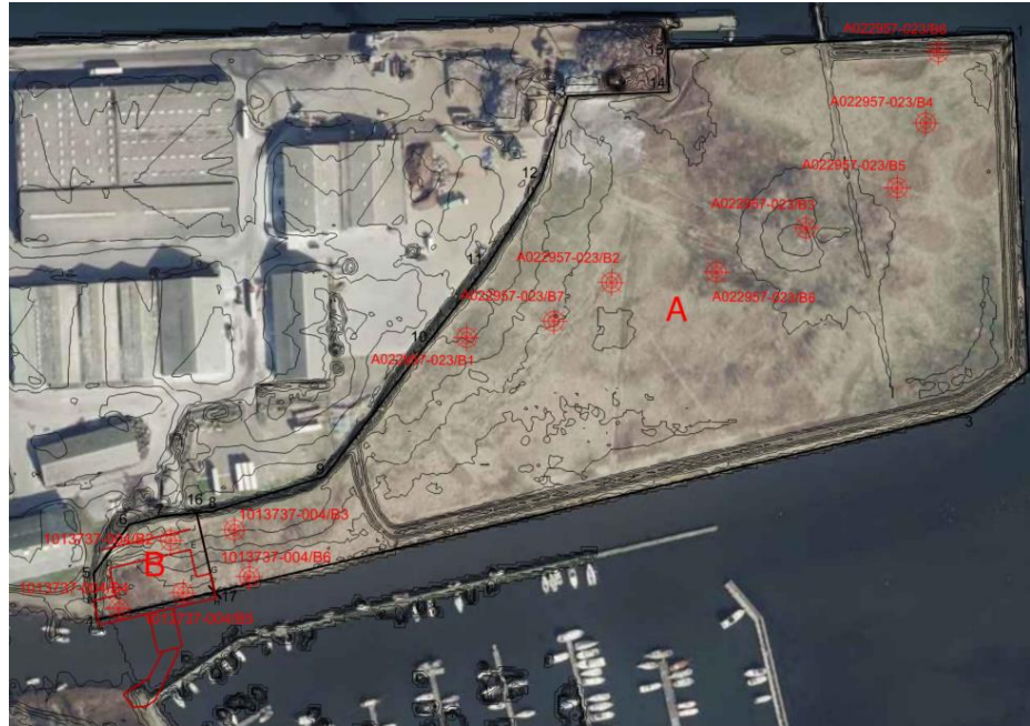
Figur 3-2 Situationsplan inkl. boringer. Med rødt ses spuns og med sort streg afgrænsningen af områderne. Koordinater fremgår af bilag B.
