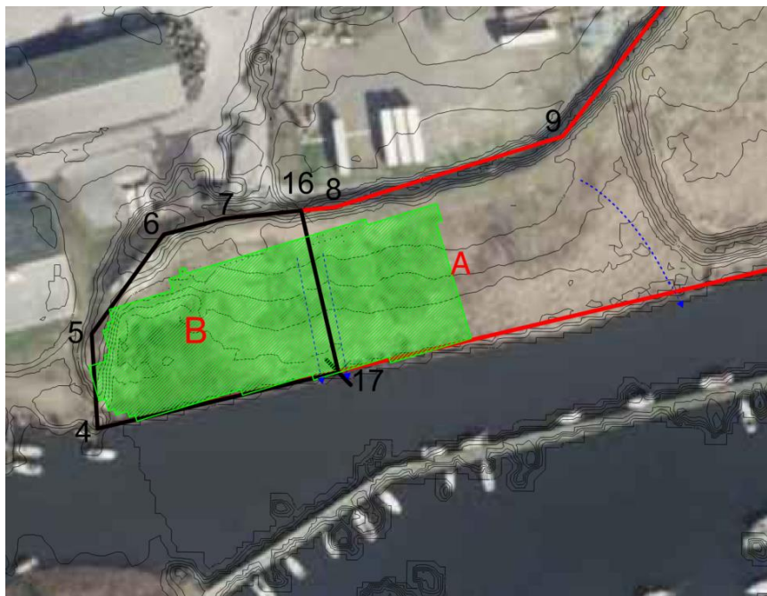
Figur 6-1 Opmåling af Kolding Havns sedimentdepot fra d. 21. april 2021. De blå pile angiver overfladevands transportvej. Med grønt ses det område der er cementstabiliseret.
