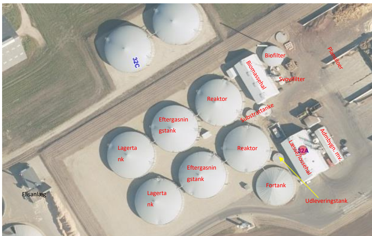
Fig. 3 Indretning af Grønhøj Biogas
