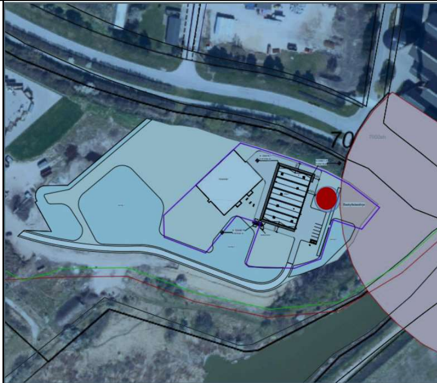
Figur 1 - Oversigt over området med bygning for varmepumpe/elkedelanlæg og varmeakkumuleringstanken angivet med rød tætp af beskyttelseslinien.
