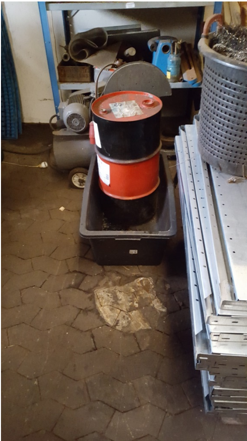
Foto: Korrekt opbevaring af olieaffald i tønde i kasse.
