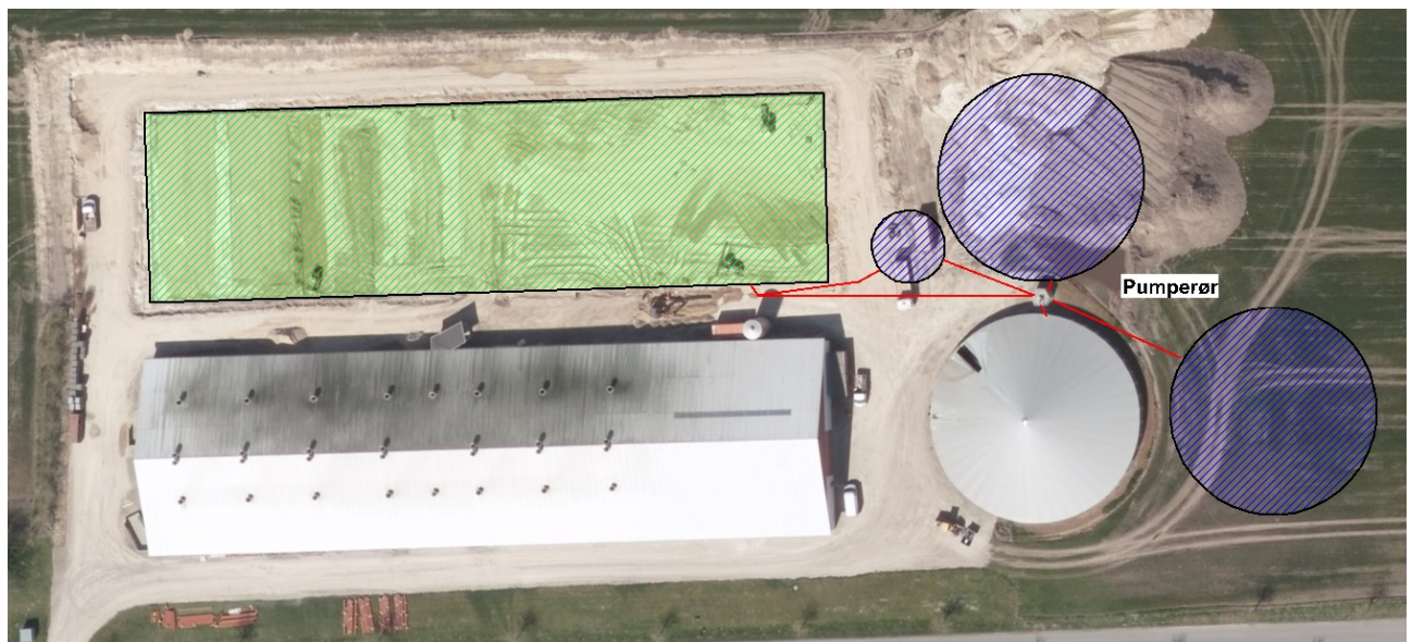
Billede 3 Placering af gylletanke med rørføring
