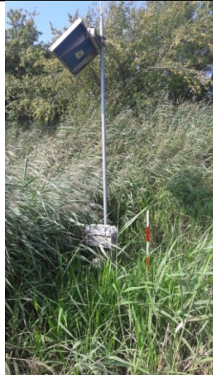
P3 - perkolatpejlebrønd. Skulle have samme opbygning som P4. Recirkuleret perkolat havde samlet sig på indersiden af den vertikale lermembran, hvilket forhindrede nærmere fotos
