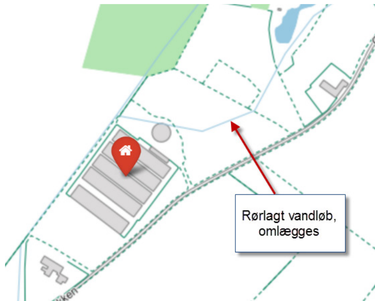
Figur 4. Omlægning af rørlagt vandløb
