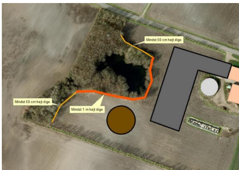
Figur 3. Eksisterende dige til beskyttelse af sø mod forurening ved uheld. Det er vilkår fra miljøgodkendelsen 2014.
