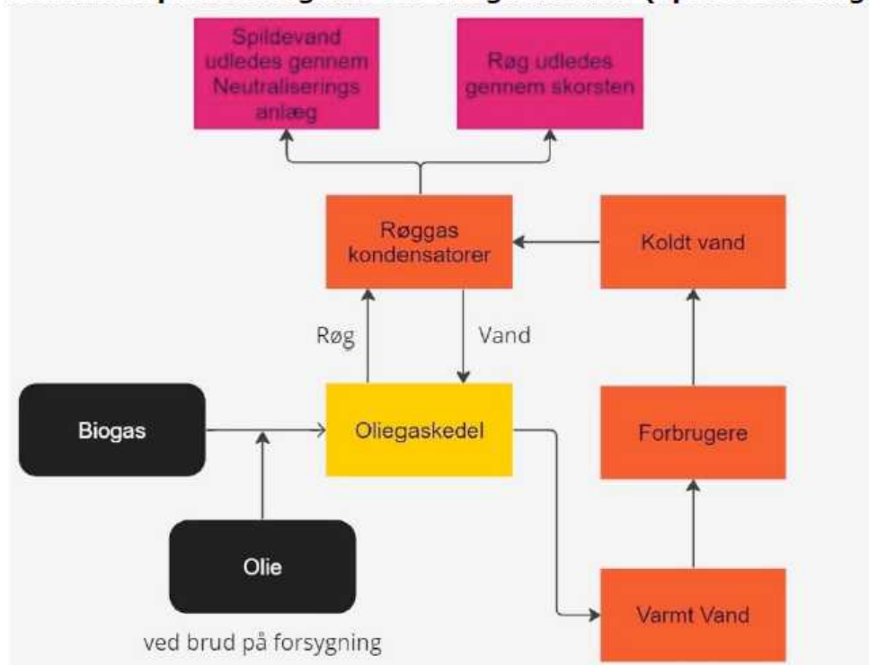
Figur 64: Procesdiagram for kedlen
