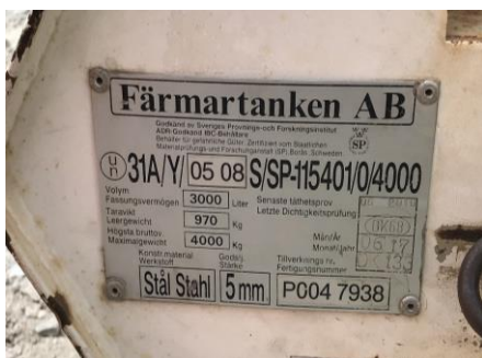
Mærkeplade på 3.000 l mobil dieseltank
