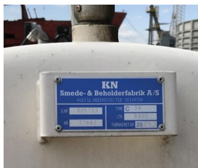
Mærkeplade på 5.900 l mobil dieseltank
