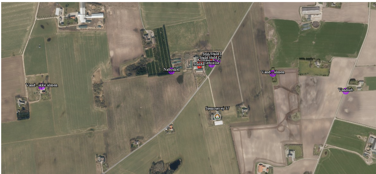
Figur 2. Afstandskrav fra produktionsarealet, af denne figur fremgår matrikelskel, vej, beboelse, vandværker, nærmeste å.
