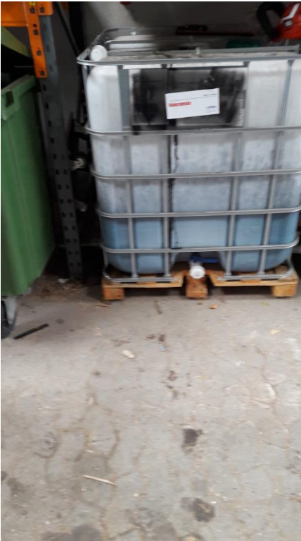
Figur 10 1.000 L pallettank til indleveret kølevæske. Står på SF-stenbelægning.
