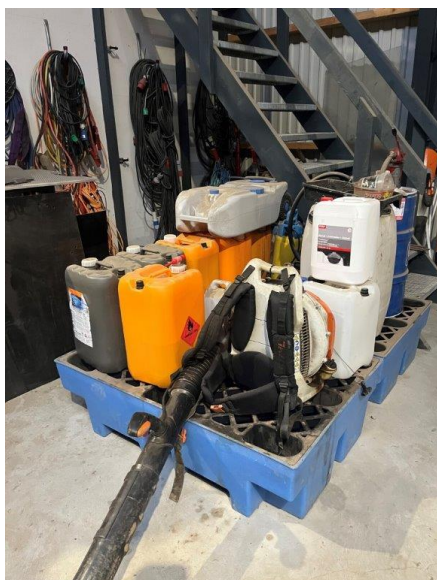
Figur 5 Spildbakke i lagerhal
