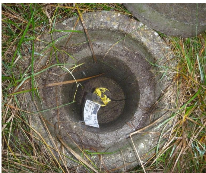
Foto 3: Grundvandskontrol boring GKB19
