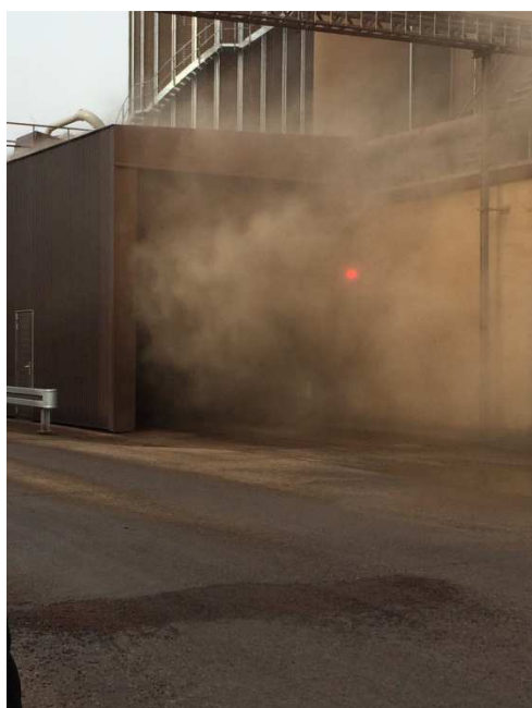
Foto 2 Det nye læsseanlæg gav anledning til meget diffust støv.
