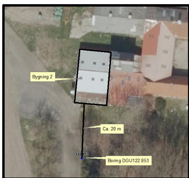
Figur 4. Boring i forhold til stald (bygning 2).
