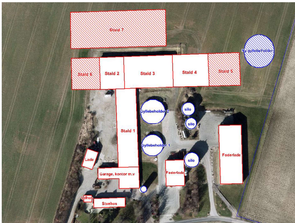
Figur 1.2: Oversigtstegning over husdyrbrugets bygninger, siloer og gyllebeholdere. De skraverede elementer er ikke eksisterende.
