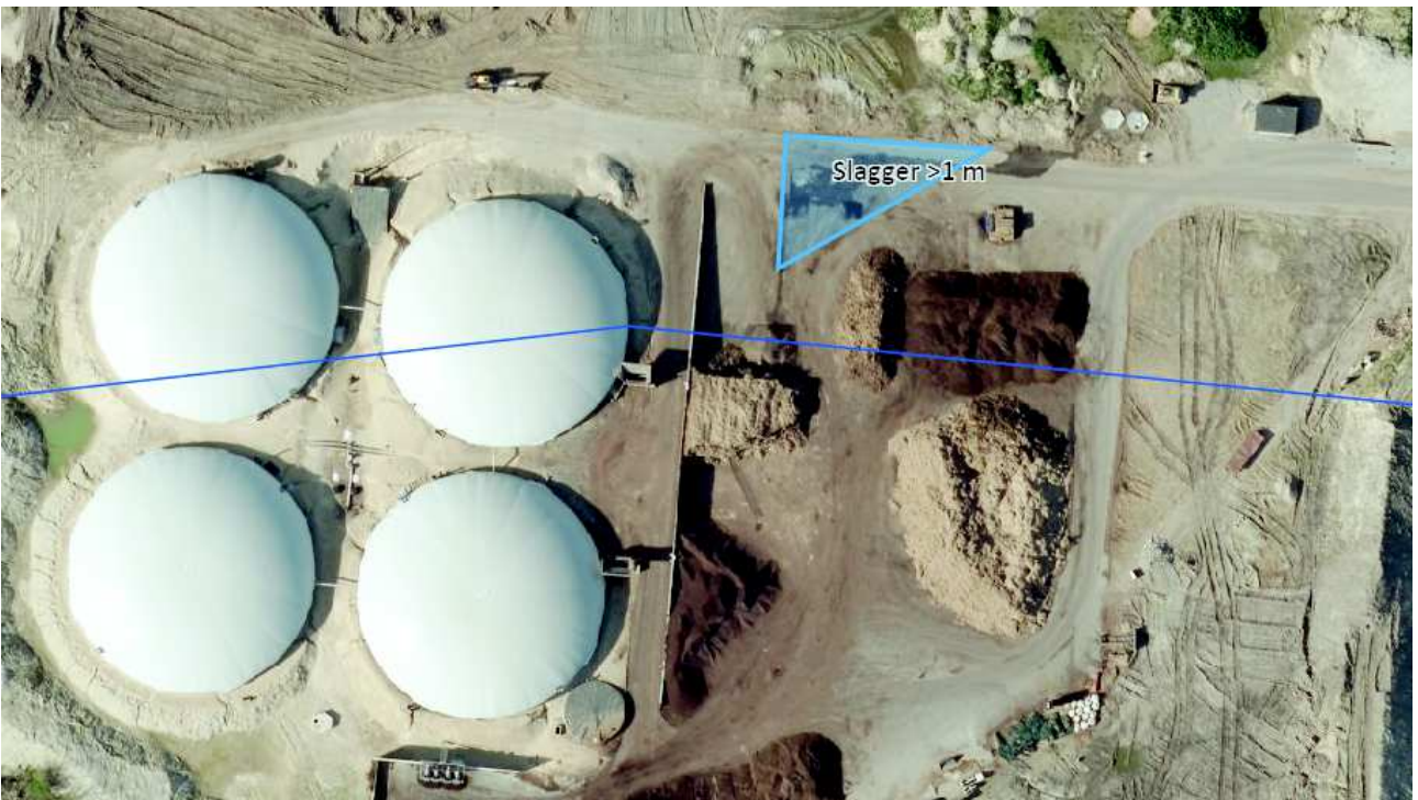
Kort visende det område, hvor der er udlagt slagger i en tykkelse på mere end 1 m. Den blå streg under området markerer grænsen på et såkaldt indvindingsopland til Vejby Smidstrup Vandværk.
