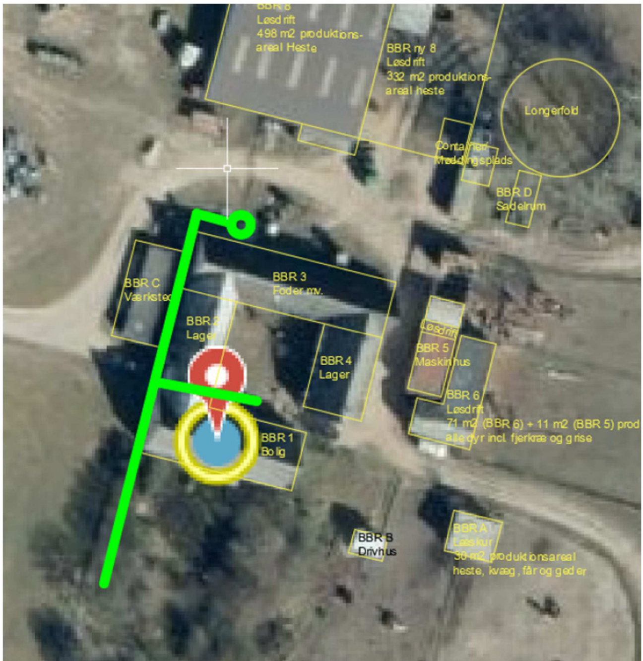
Figur 10 Afløbskort over husdyrbruget. Den grønne streg angiver regnvandsledning, der har overløb i gårdsplassen.
