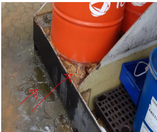
Spildbakke med topåbning - fyldt med oliehold. Spildbakke med topåbning vand, der løber over på SF-sten.
