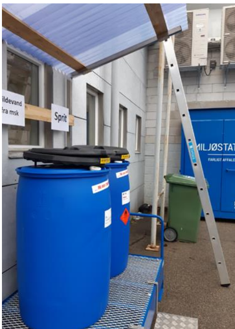
Miljøstation - Spildbakke under tag. Stort miljøskab i baggrunden
