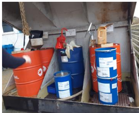
Spildbakke med topåbning - fyldt med oliehold. Spildbakke med topåbning vand, der løber over på SF-sten.
