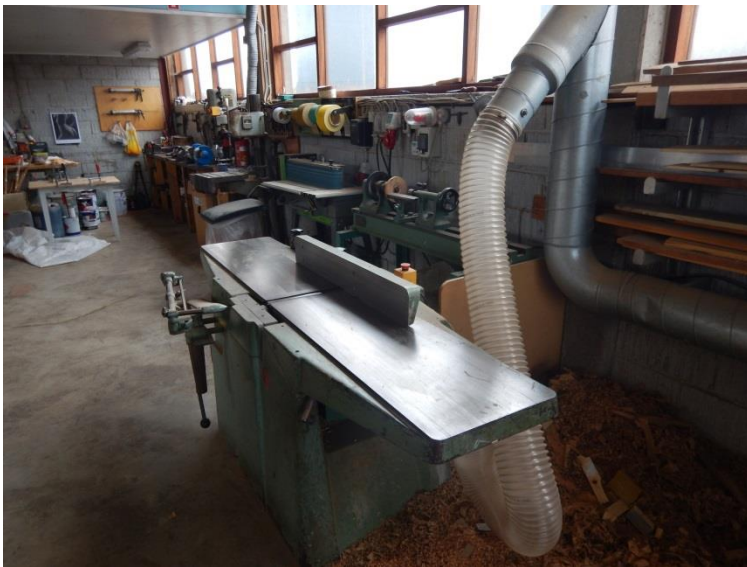
4. Station med punktudsug.
