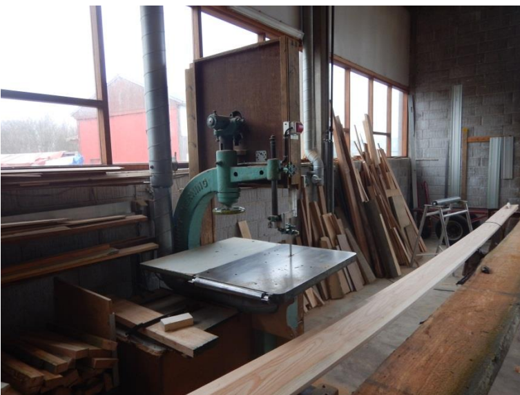
8. Station med punktudsug.
