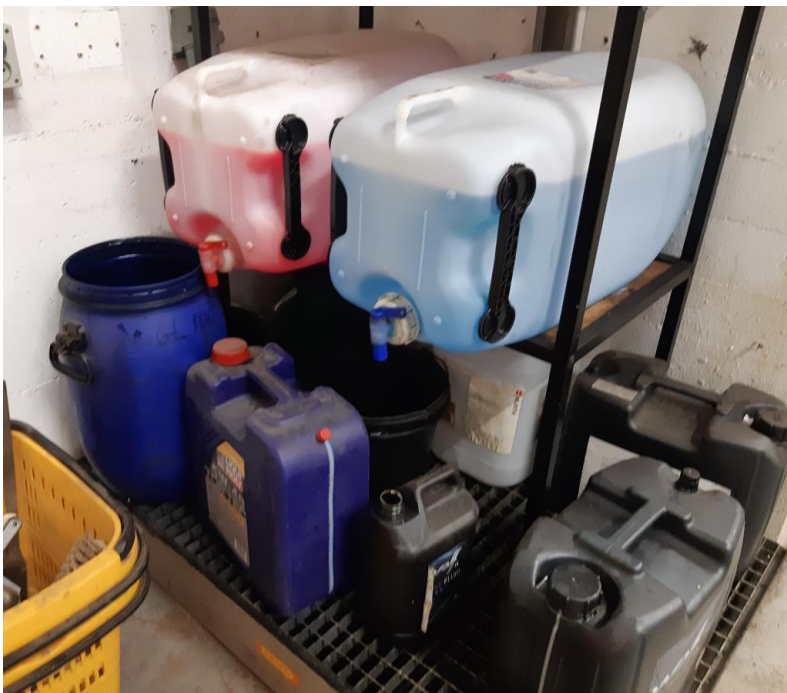
Ny sprinkler- og bremsevæske på real. Spildolie, brugt bremse- og kølevæske mm i dunke på spildbakken.
