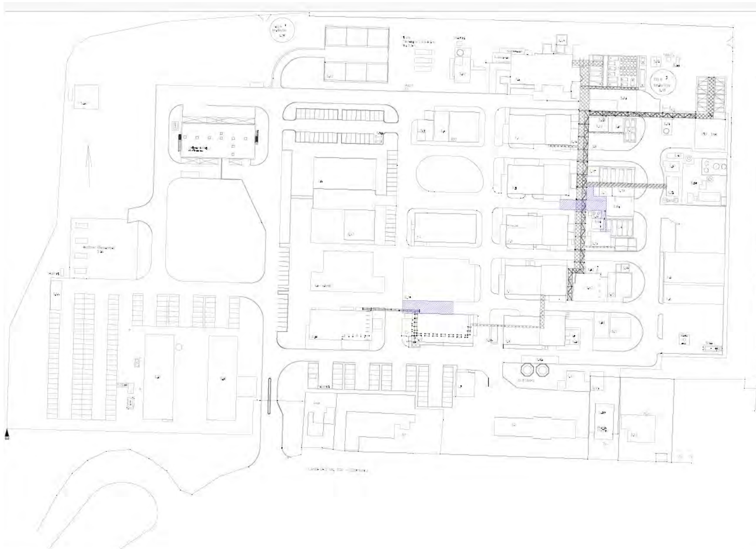
Figur 4.4 De blåskraverede arealer er arealer, hvor belægningen udskiftes, så der ikke fremadrettet sker udvaskning af PFAS-stoffer fra belægningen.
