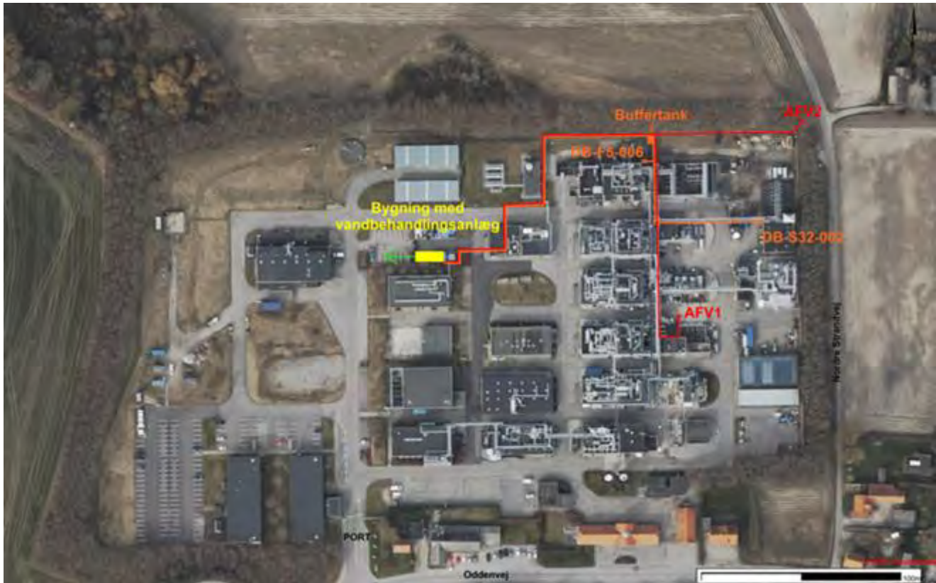
Figur E.1: Lundbecks produktionsområde, og placering af bygning med vandbehandlingsanlæg og rørsystemet. Tegningen viser rørføring fra AFV1 og AFV2 samt to bygningsdræn. Den endelige rørføring kan komme til at se anderledes ud, da der evt. skal tilsluttes andre omfangsdræn.
