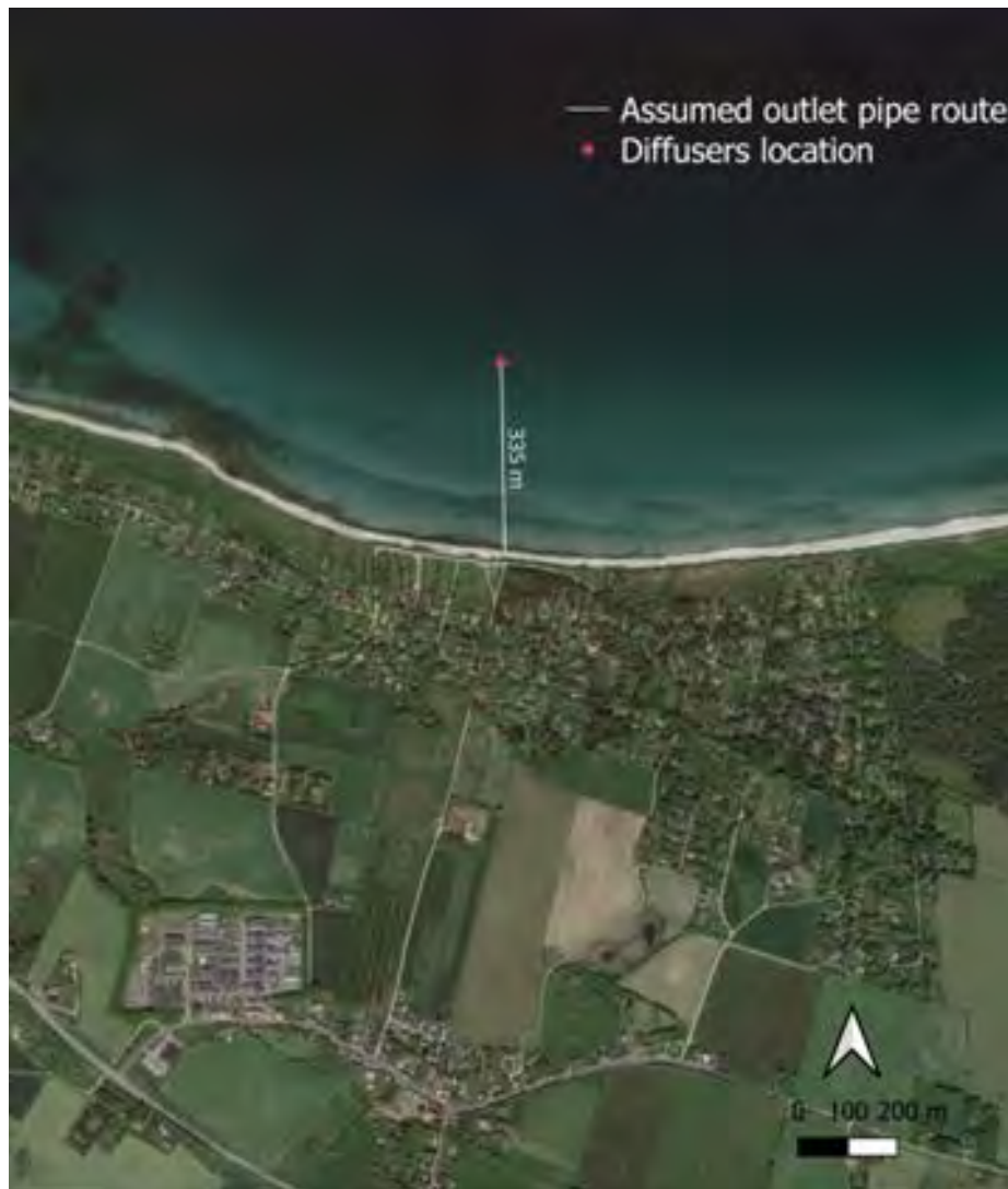
Figur 2.1: Antaget placering af udløbsledning samt diffusorplacering.
