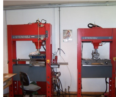
To hydrauliske pressere for hhv. skjold og låg
