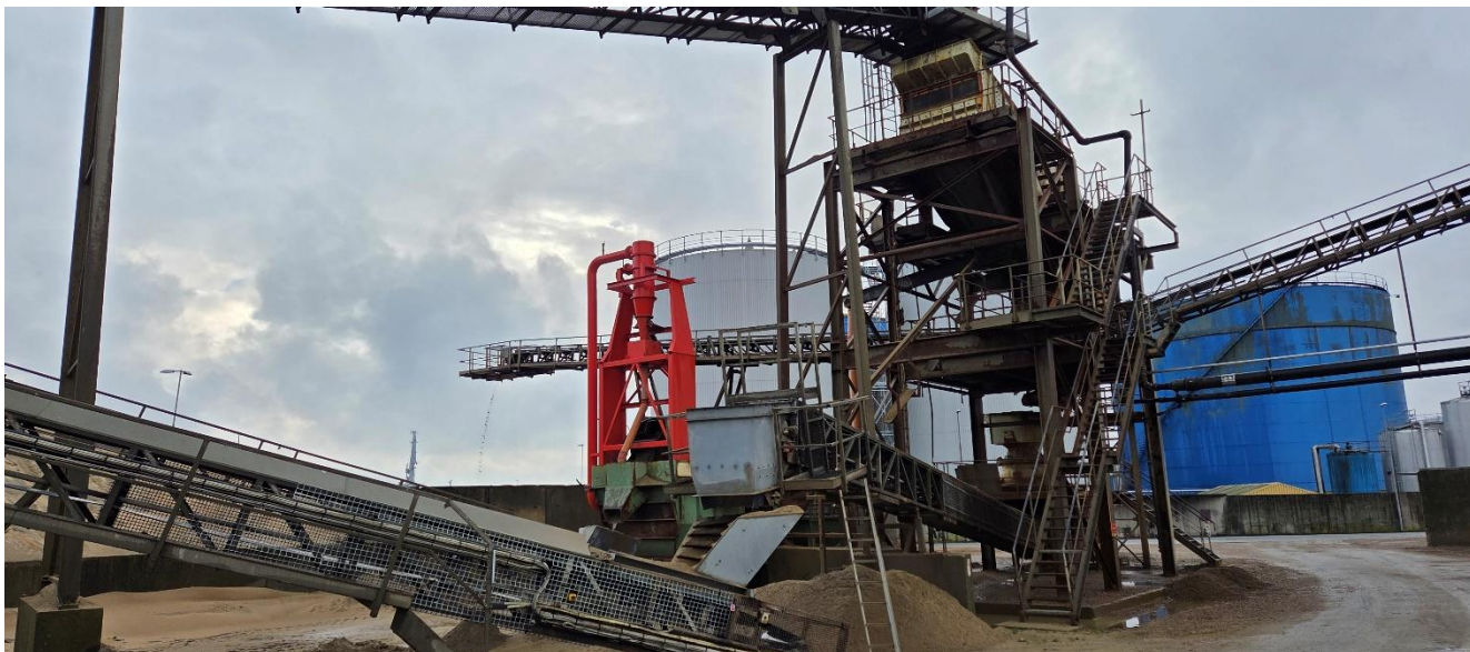
Cyklon (den røde) renser for suspenderet stof inden udledning af skyllevand.
