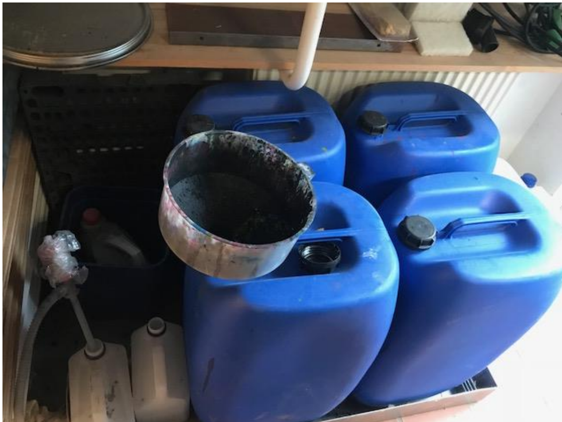
Billede 2. Opbevaring af kemikalieaffald i dunke på spildbakke.
