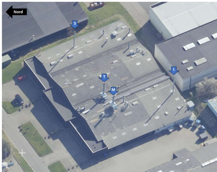
Figur 4: Oversigtskort over Formervej 4, med placering af afkast fra de to malerrobotter "Stor" [S] og "Lille" [L], samt den manuelle kabine [M] og den tilhørende tørrekabine [T].
