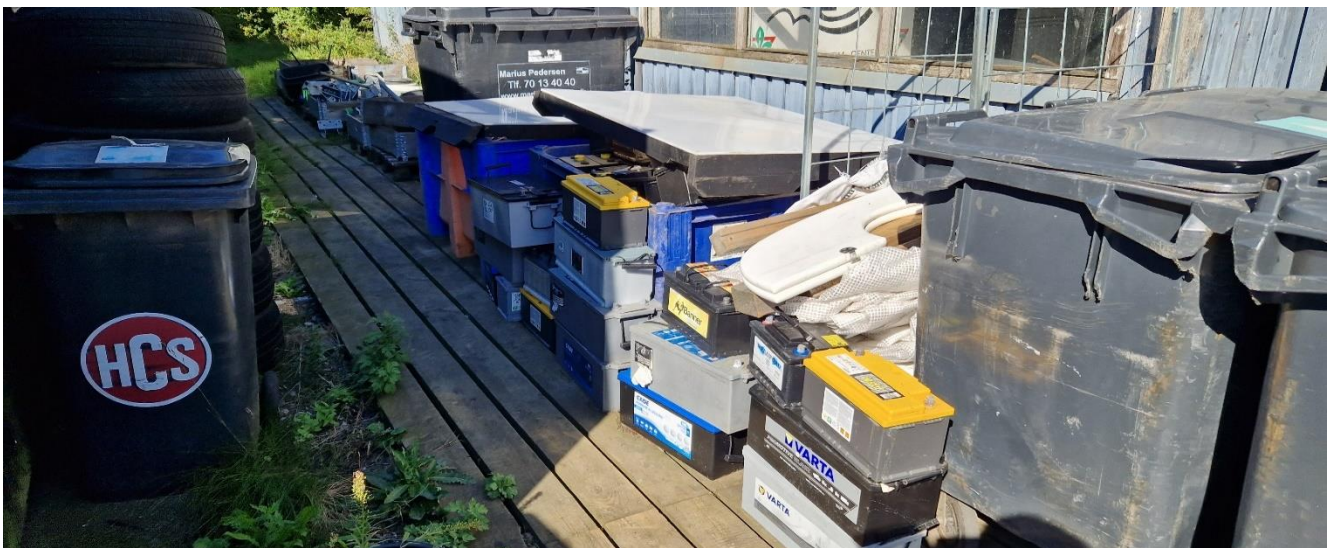
Akkumulatorer opbevares i syrefast kasse med låg. Der er dog p.t. ikke plads til alle i kassen.
